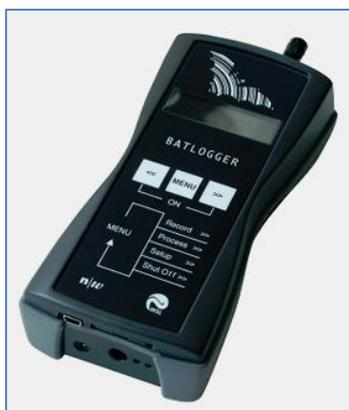
Abb. 5: BAT-Detektor zur Aufzeichnung von Fledermausrufen mit zusätzlicher Track-Aufzeichnung
